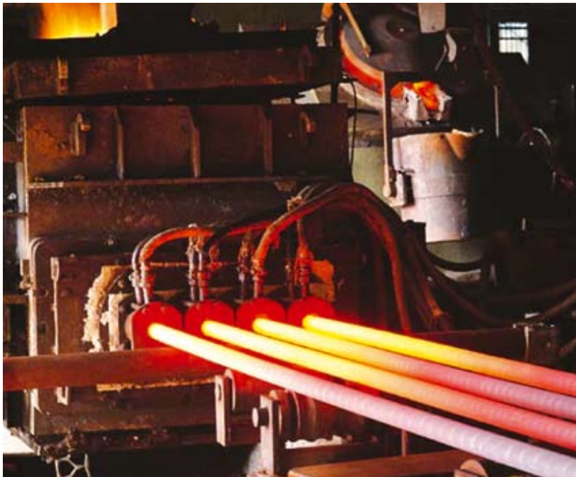
Barras de ferro nodular são produzidas por meio do processo de fundição contínua horizontal
