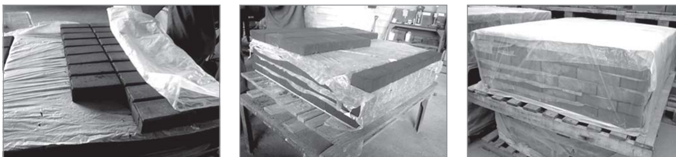
Figura 3. Esquema do processo de cura das peças de concreto.
